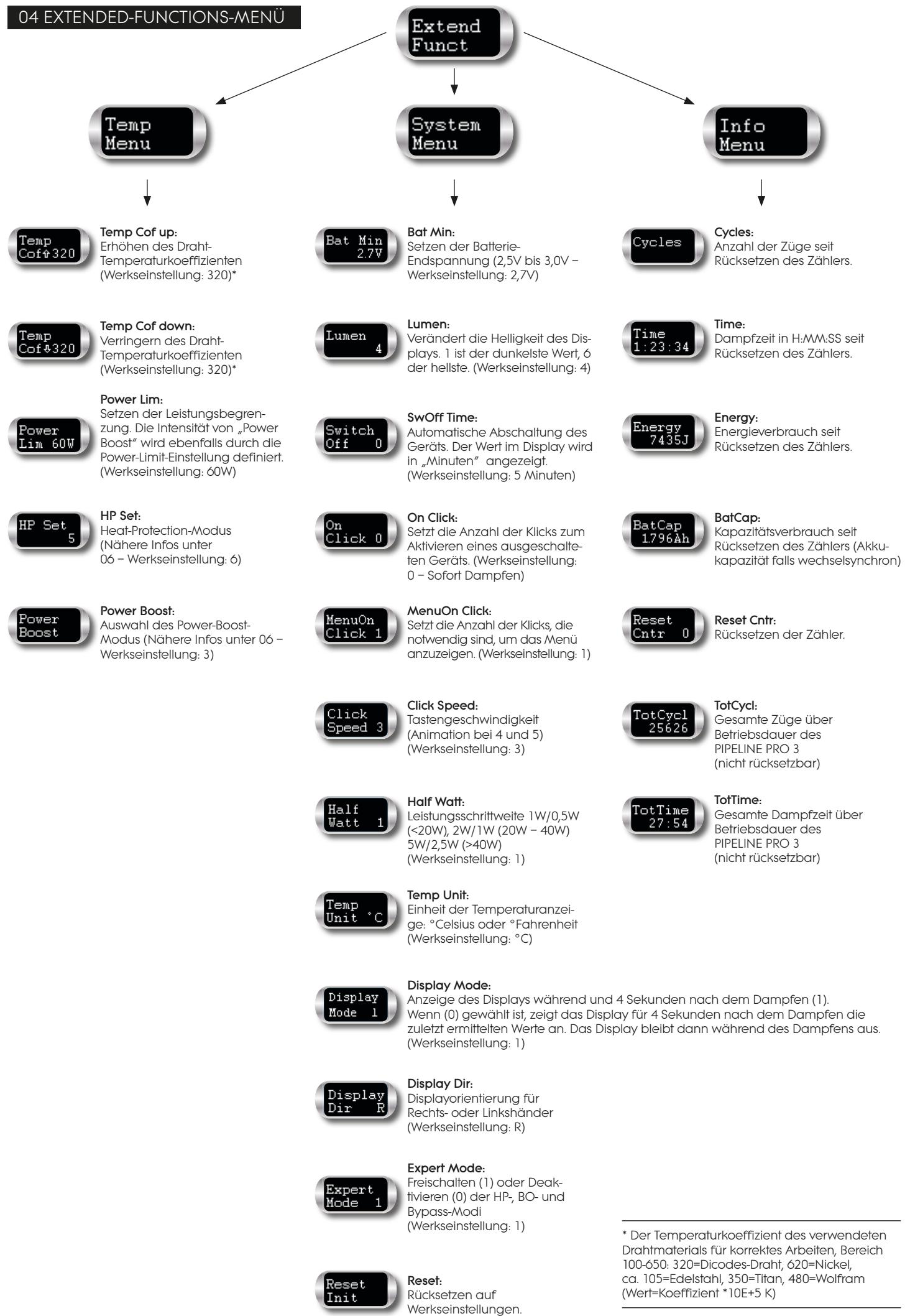
\* Der Temperaturkoeffizient des verwendeten Drahtmaterials für korrektes Arbeiten, Bereich 100-650: 320=Dicodes-Draht, 620=Nickel, ca. 105=Edelstahl, 350=Titan, 480=Wolfram (Wert=Koeffizient \*10E+5 K)
