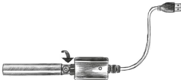
Brancher le chargeur PIPELINE à une prise USB ou à une prise murale. La lumière du chargeur est verte. Une fois le chargeur branché, visser la batterie à charger dans la prise ronde prévue à cet effet ; le bouton de la batterie se met alors à clignoter et la lumière du chargeur devient rouge.
