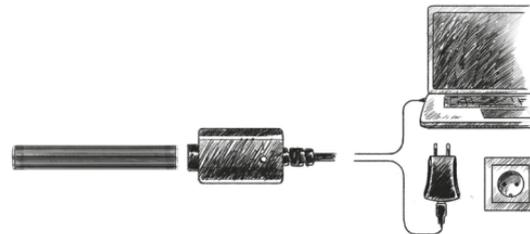
Brancher le chargeur PIPELINE à une prise USB ou à une prise murale. La lumière du chargeur est verte.
