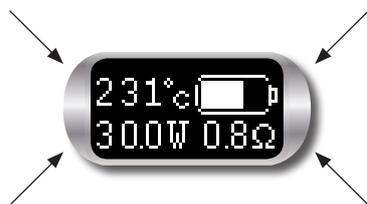
Affichage de la puissance. En mode Bypass (non régulé), la puissance réelle est indiquée.
